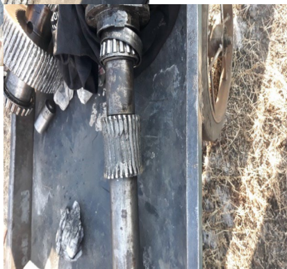
ВАГОН ТҮЛХЭГЧ А-1-Р РЕДУКТОРЫН 1-Р ГОЛЫН АРААНЫ ЭЛЭГДСЭН БАЙДАЛ
